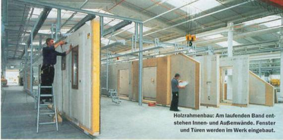
Holzrahmenbau: Am laufenden Band entstehen Innen- und Außenwände. Fenster und Türen werden im Werk eingebaut.
